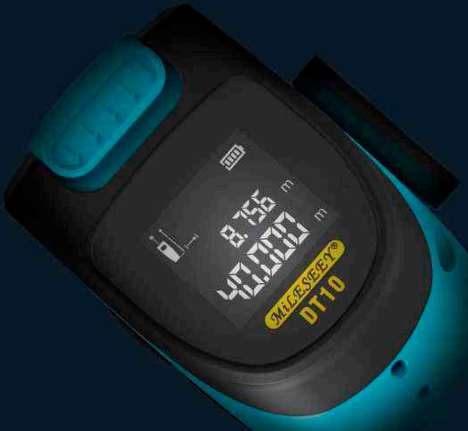
Измеряет металлической лентой расстояние до 5 метров, а лазерным лучом - до 40 м. Запоминает последние 20 измерений, а кнопка Set позволяет посмотреть их историю. Встроенный литий-полимерный аккумулятор емкостью 380 мАч позволяет работать не прерываясь.
