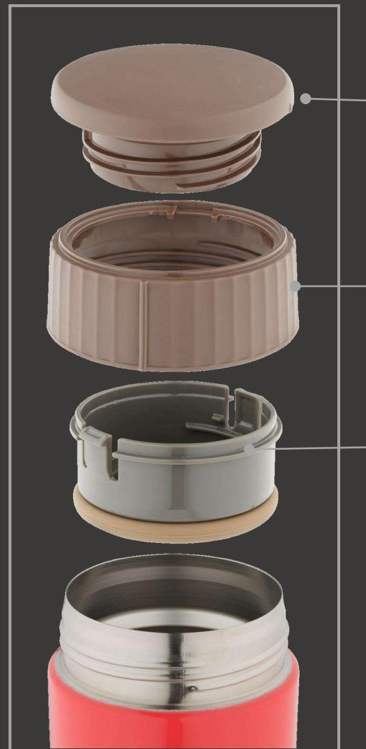
Специальная многоуровневая конструкция крышки-пробки позволяет легко открывать термос с горячим содержимым – достаточно повернуть верхнюю крышку на четверть оборота, не выкручивая её полностью, и она сработает как спусковой клапан.
